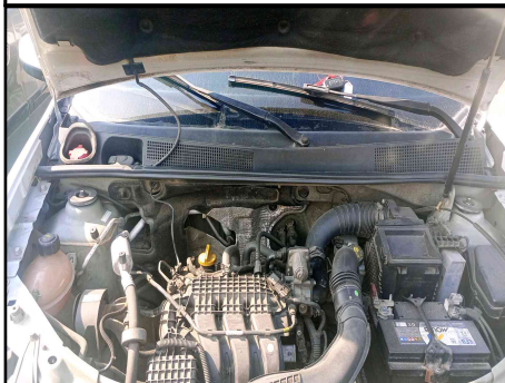
PAINEL CORTA FOGO
