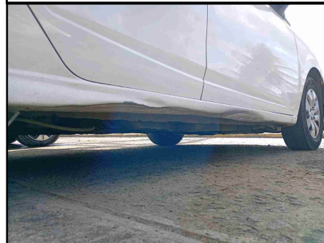
CAIXAS DE AR - SOLEIRA DIREITA
