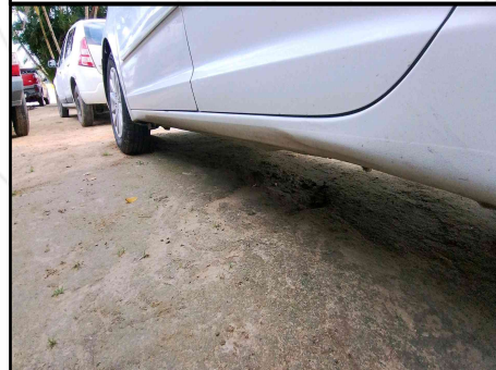
CAIXA DE AR/ SOLEIRA ESQUERDA
