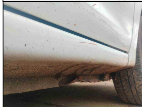
CAIXAS DE AR - SOLEIRA DIREITA
